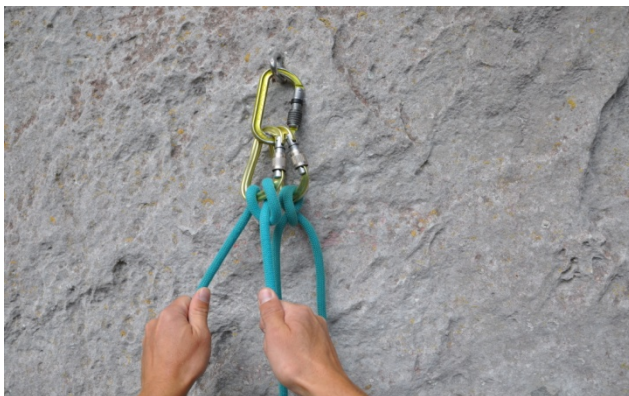
Abb. Karabiner Zentralpunkt an einem Bohrhaken
