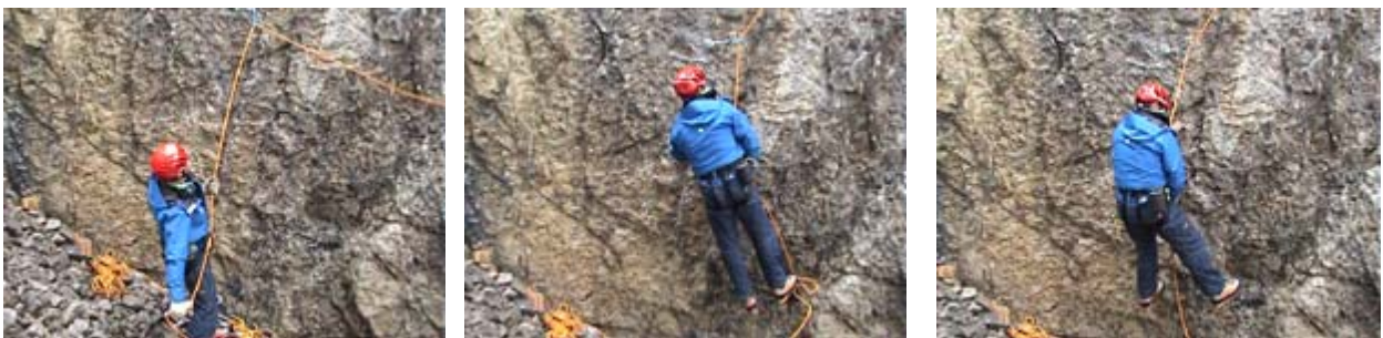
Abb. Tuber-Körpersicherung im Test – Bgf-Fortbildung 2012 (60 kg starre Masse, Sturzfaktor 0,6)
