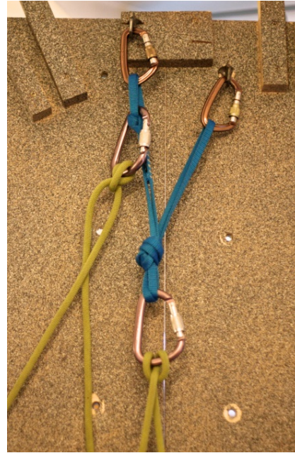
Abb. Fixiertes Kräftedreieck mit Standplatzschlinge
