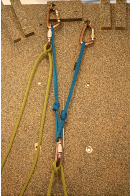
Abb. Beidseitig abgebandener Ausgleich
