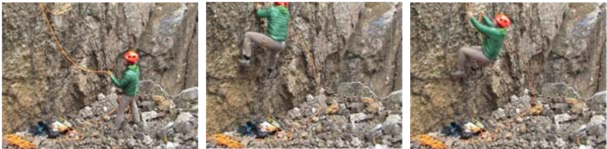
Abb. Grigri-Körpersicherung im Test - Bgf-Fortbildung 2012 (60 kg starre Masse, Sturzfaktor 0,6)
