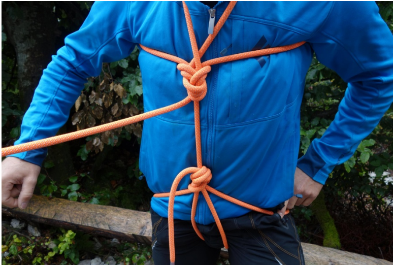
Abb. Sitz-Brustgurt-Kombination mit Hauptseil Aufbau
