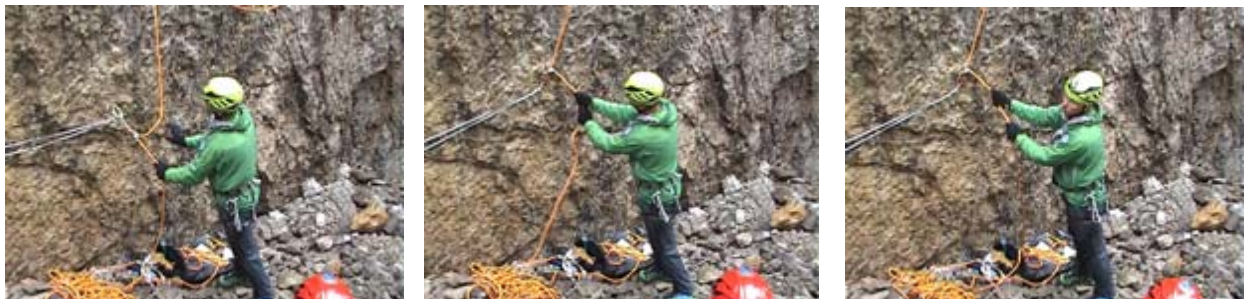
Abb. Fixpunktsicherung im Test – Bergführerfortbildung 2012 (60 kg starre Masse, Sturzfaktor 0,6)
