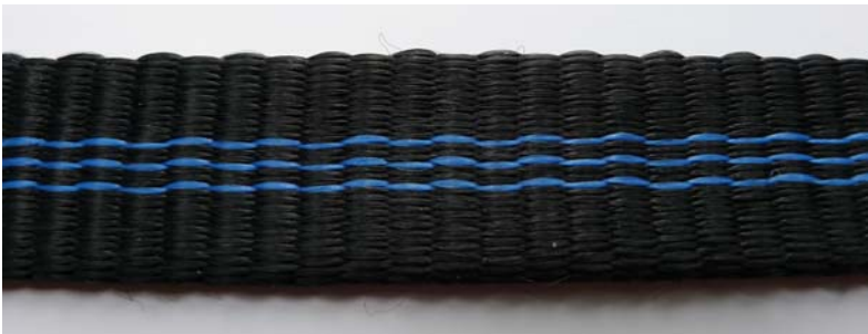
Abb. Bandmaterial mit drei Kennfäden (15 kN Bruchfestigkeit)
