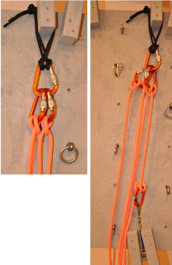
Mittels Ankerstich abgebundene Köpfl/Sanduhrschlinge erhöht die Sicherheit durch den fixierten Doppelstrang. Bei Abspannung nach unten ist eine Zugbelastung nach oben möglich.
