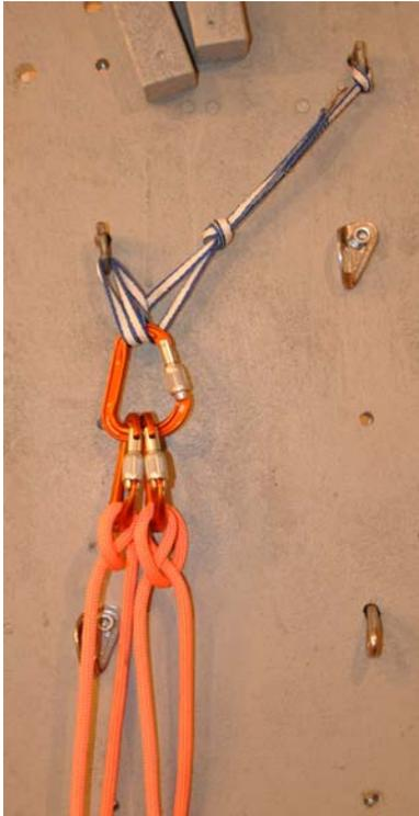
Die Bandschlinge wird mittels Ankerstich im oberen Normalhaken eingefädelt und mittels Sackstich abgebunden. Zwischen Sackstich und unterem Normalhaken wird durch Eindrehen ein Ausgleich erzeugt. Diese Standplatzvariante kommt vor allem bei schlechten Normalhaken zur Anwendung.
