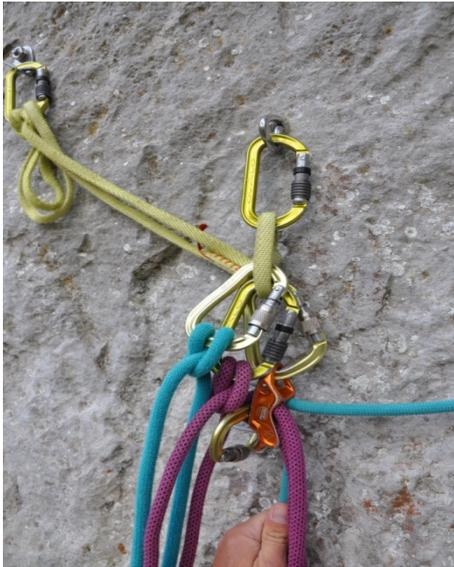
Nach einem Quergang wird der erste Geführte, wenn er am Standplatz angekommen ist, mittels Mastwurf (und nicht wie gewöhnlich in der Plate mit einem Sackstich) selbstgesichert. Ansonsten kann die Plate bei einem Sturz des zweiten Gastes nicht „aufdrehen“ und blockieren.
