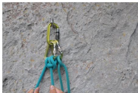
Abb. HMS mit Bremskraftverstärkung
