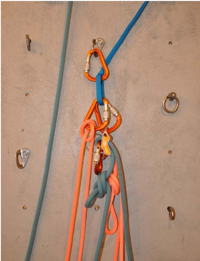
Abb. Fixpunktsicherung mittels HMS und Sicherung an nur einem der beiden Seile. Bei 3-fach zertifizierten Seilen - Sicherung über HMS am Einzelstrang (orange Seil). Das Seil des 2. Nachsteigers (blaues Seil) wird bei gerader Seilführung nicht eingehängt.
