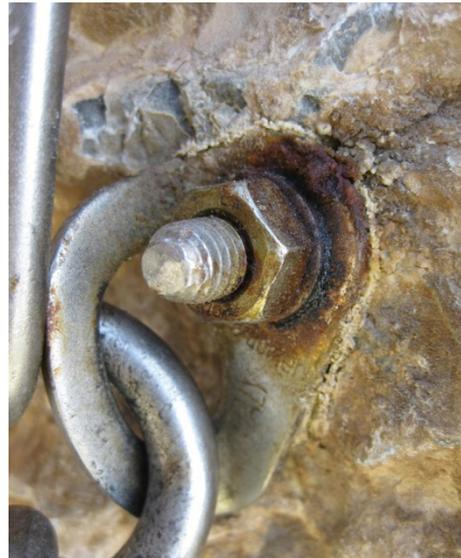
Abb. Korrodierter Bolt in Meeresnähe
