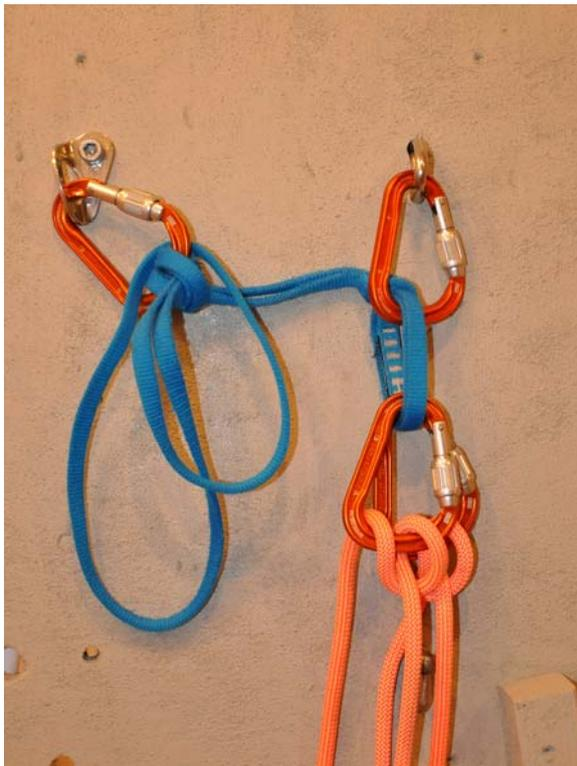
Fixierung mittels Mastwurf und Sicherung der Schlaufe im Karabiner weitere Möglichkeiten: mittels Sackstich, Wickeln oder Komplettablängung (eher im Eis)
