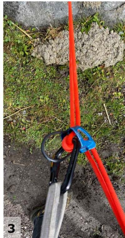
■ **Ablassen über Fixpunktumlenkung und Körper** (Bergführer zuerst)
