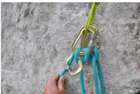
Abb. HMS mit Rücklaufsperrre
