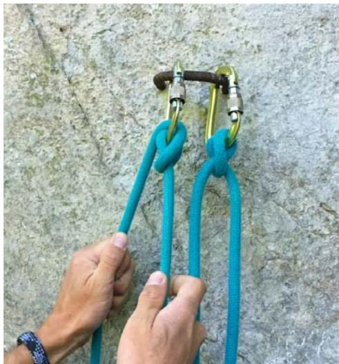
Abb. Klebeanker - solider Torstahlbügel
