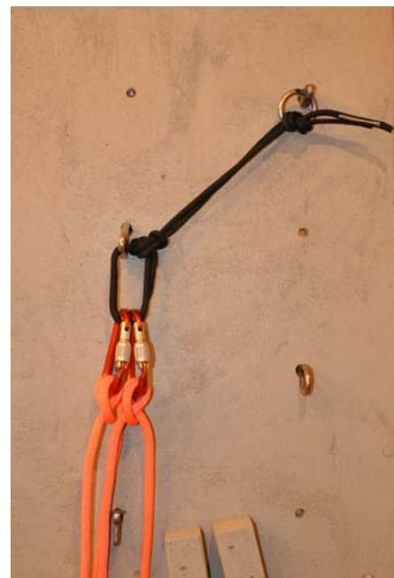
Abb. Kräfteverteilung mittels gefädelttem Bulin
